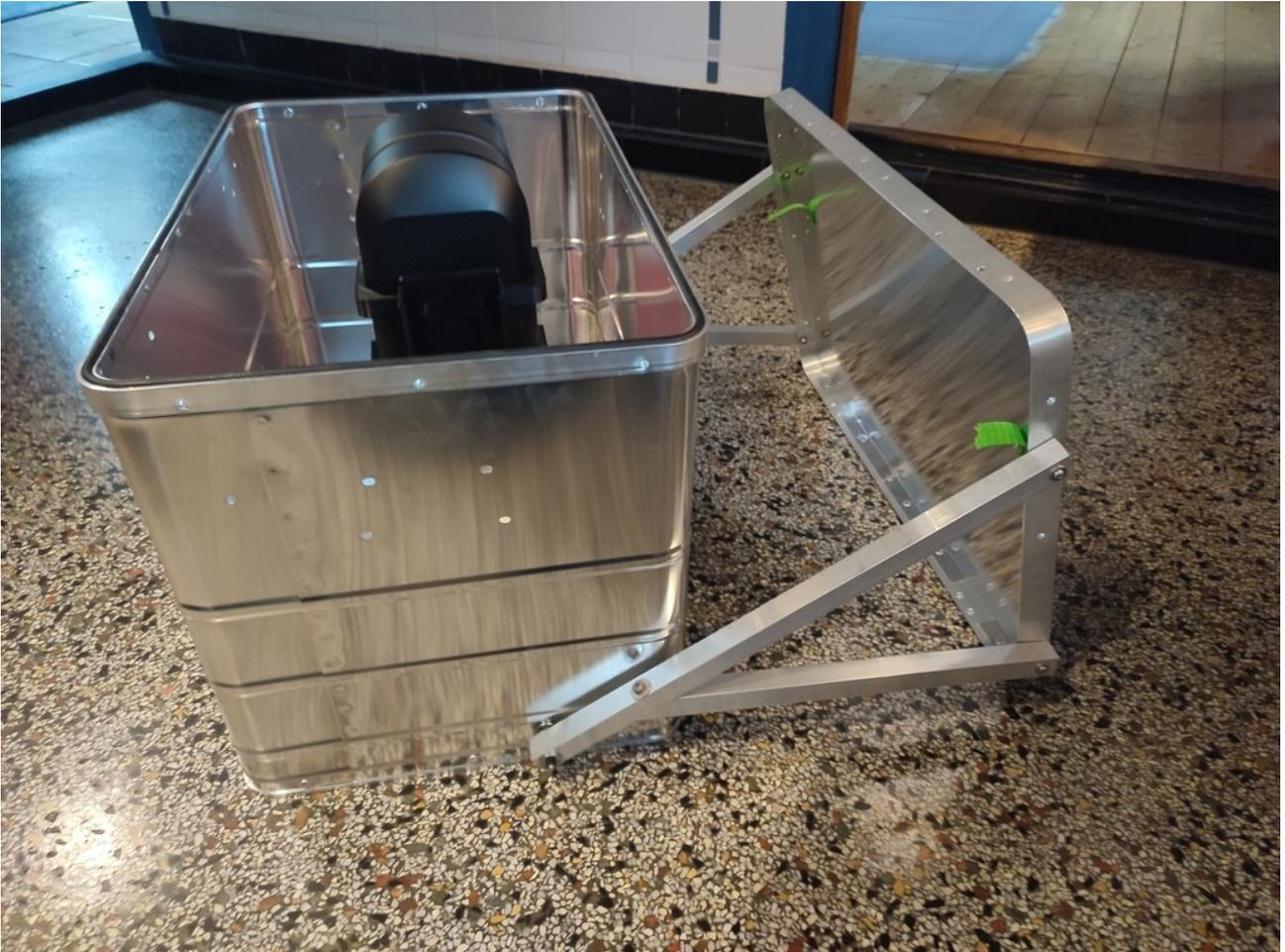
Der Linearmotor wird so an der Kiste montiert, dass er das Dach ganz aufklappen kann:
