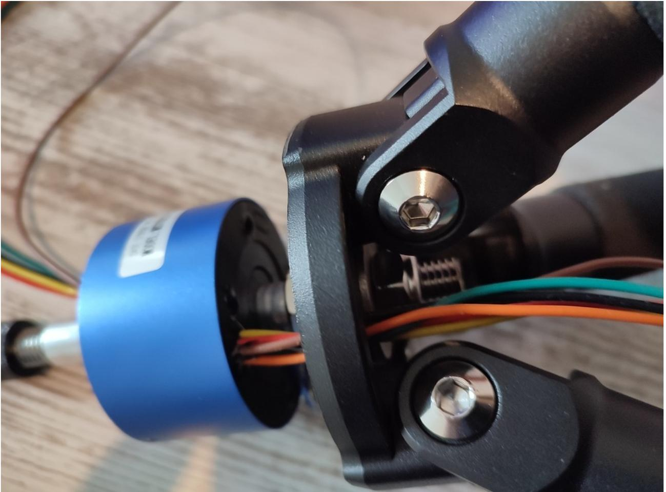
Der Schleifring hat eine innen liegende Verdrehsicherung (= ein kleiner Flansch), die mit zwei Schrauben befestigt ist.
