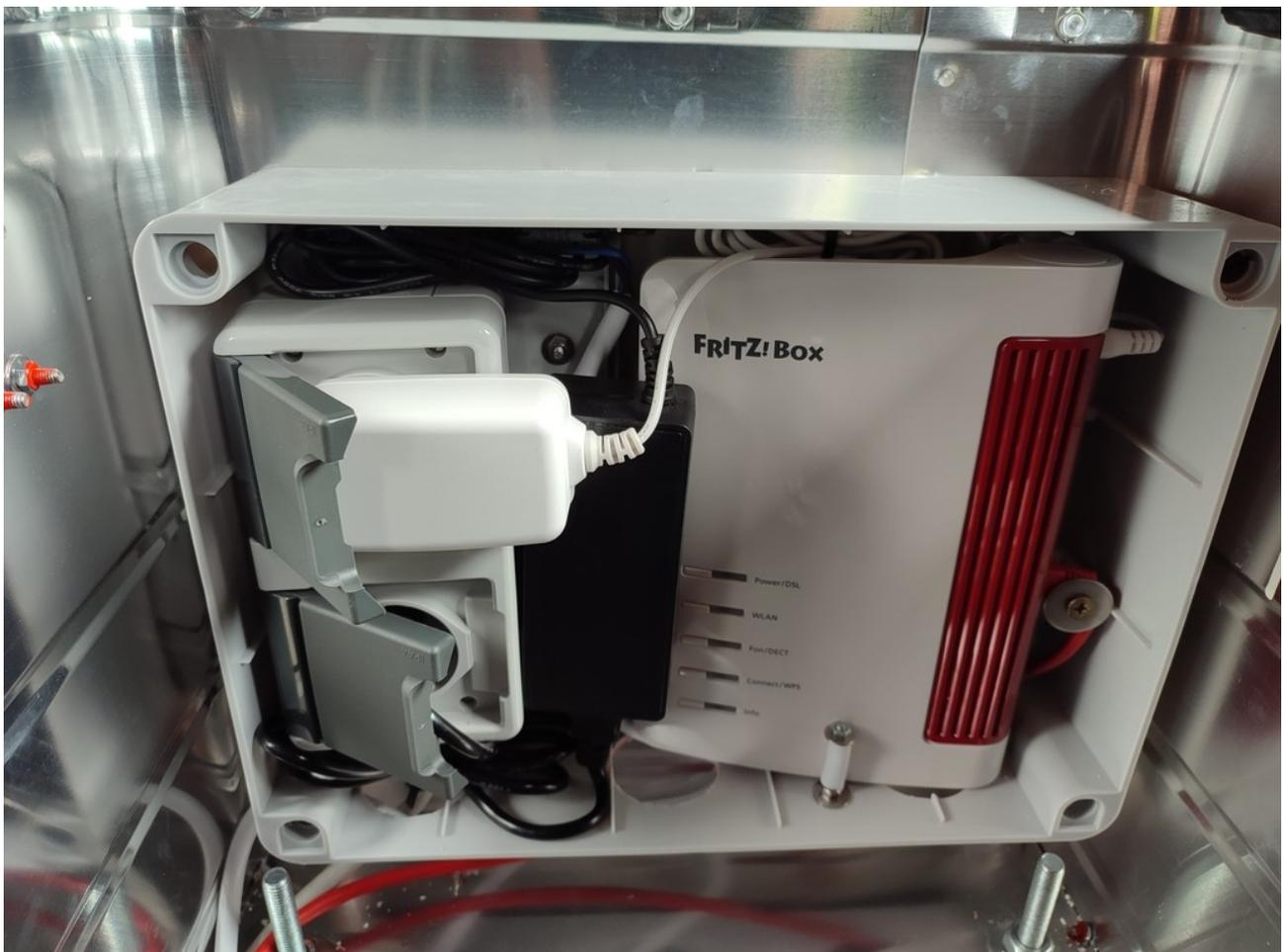
Im Fritzbox-Gehäuse habe ich zwei Steckdosen untergebracht: eine für die Fritzbox und zusätzlich eine für das Netzteil für alle 12V-Geschichten (Aktuator/Motortreiber, Lüfter, Relaisplatine, Hubmagnet-Einschalter) und das 12V-Netzteil hatte auch noch Platz.
